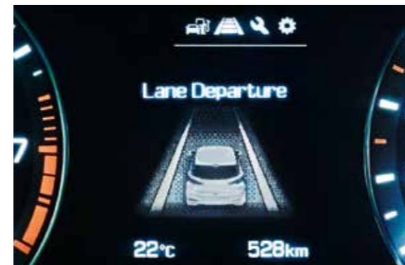
Spurhalteassistent. Sofortige visuelle und akustische Warnung bei unbeabsichtigtem Verlassen der Fahrspur.
